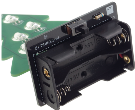
Fot. 13 Koszyk baterii z zaznaczonymi biegunami baterii
