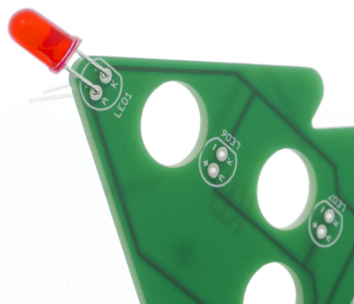
Fot. 3 Dioda LED przed przylutowaniem
