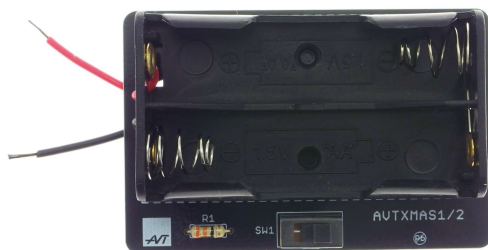
Fot. 6 Przyklejony koszyk baterii do płytki podstawy
