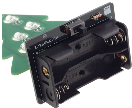
Fot. 13 Koszyk baterii z zaznaczonymi biegunami baterii
