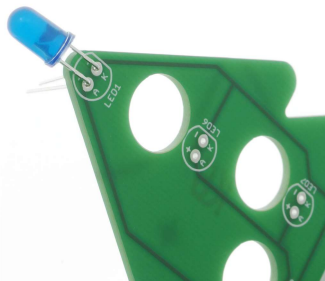
Fot. 3 Dioda LED przed przylutowaniem
