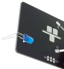
Fot. 2 Dioda LED po wygięciu nóżek
