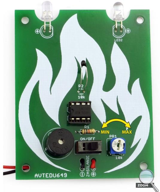
Abb. 2 Anordnung der Bauteile auf der Leiterplatte
