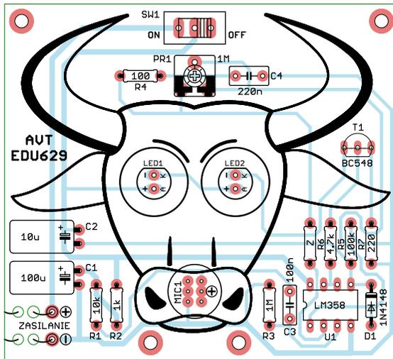
Abb. 2 Anordnung der Bauteile auf der Leiterplatte
