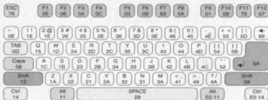
Rys. 1a. Rozkład klawiszy typowej klawiatury PC z kodami klawiszy.
