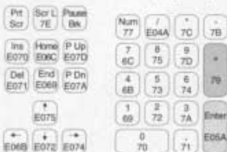
Rys. 1b. Rozkład klawiszy specjalnych i numerycznych wraz z kodami.
