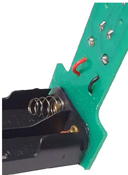
Fotografia 2. Szczegóły montażu koszyka na baterie
