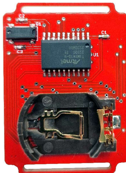
Fotografia 2. Zmontowane urządzenie retroWatch od strony warstwy BOTTOM
