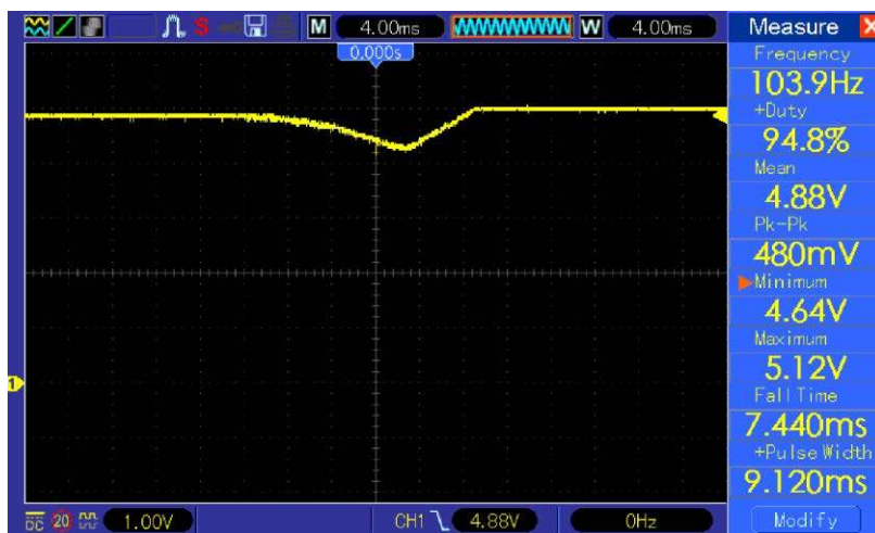
Rysunek 5. Oscylogram napięcia wyjściowego w chwili odłączenia zasilania głównego
