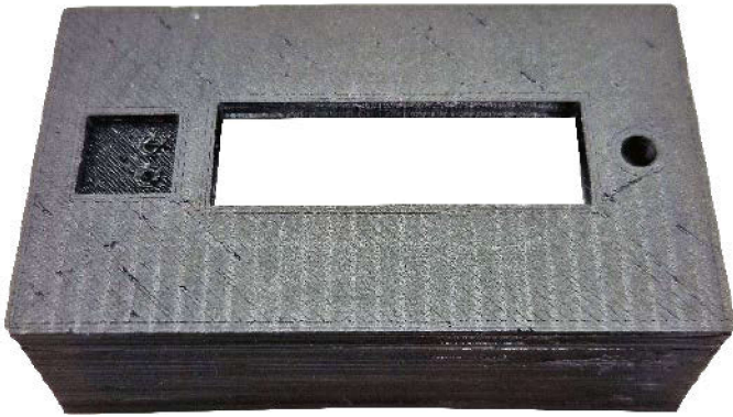
Fotografia 3. Widok obudowy urządzenia cMeter wydrukowanej w technologii FDM
