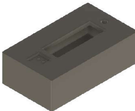
Rysunek 8. Widok 3D obudowy urządzenia cMeter
