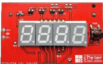
Fotografia 1. Zmontowane urządzenie cMeter od strony warstwy TOP
