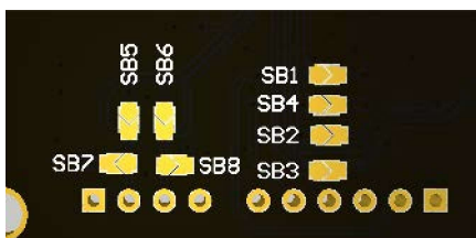
Rysunek 4. Mostki lutownicze na spodniej warstwie płytki drukowanej
