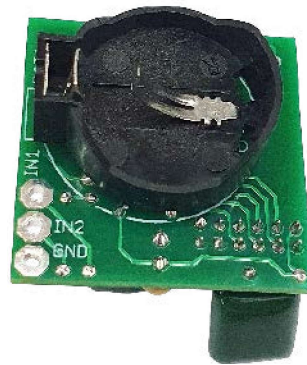
Fotografia 4. Widok zmontowanej płytki nadajnika – widok od strony baterii
