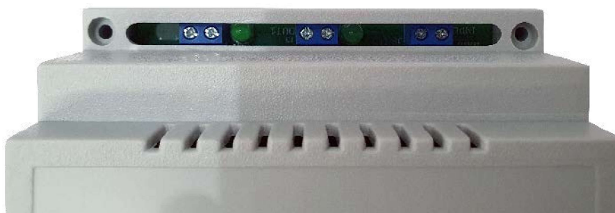
Fotografia 6. Odbiornik zamknięty w dedykowanej obudowie
