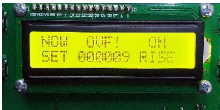
Fotografia 3. Sygnalizacja przepiętnienia licznika
