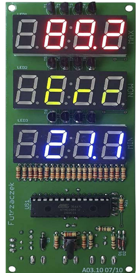
Fotografia 4. Wygląd wyświetlacza z komunikatem błędu czujnika
