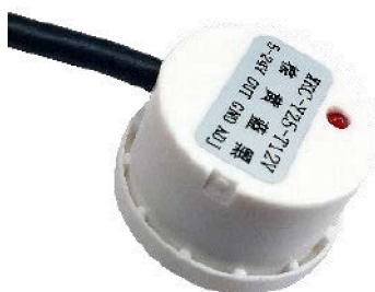
Fotografia 1. Czujnik XKC-Y25-T12Z użyty w projekcie
