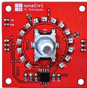
Fotografia 1. Wygląd zmontowanej płytki urządzenia toneCtrl widzianej od strony TOP (w wersji prototypowej)
