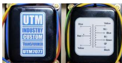
Fotografia 1. Transformator głośnikowy UTM7077
