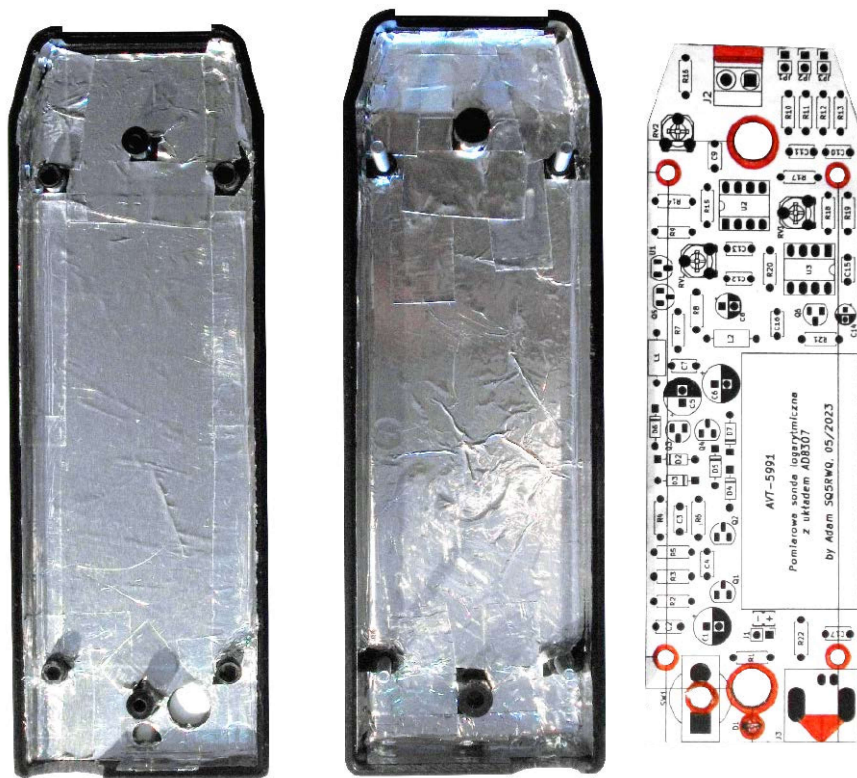
Fotografia 2. Obudowa sondy przygotowana do montażu
