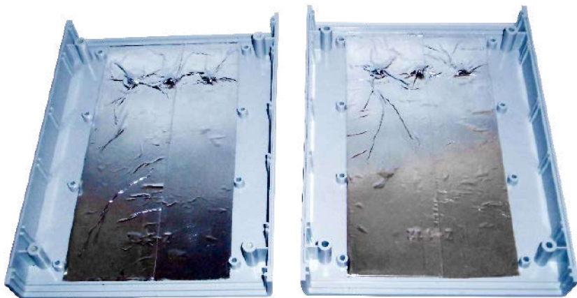
Fotografia 3. Wnętrze obudowy w trakcie ekranowania
