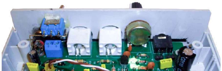
Fotografia 8. Montaż tylnego panelu odbiornika w obudowie
