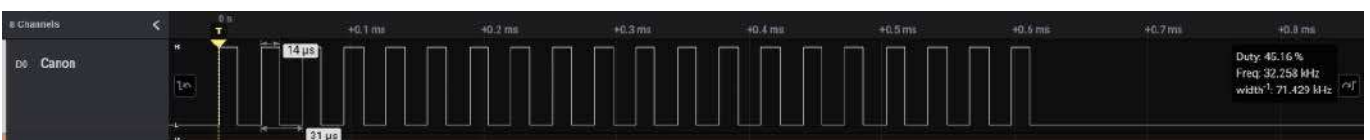
Rysunek 5. Zrzut ekranu analizatora stanów logicznych rzeczywistej ramki transmisji standardu Canona
