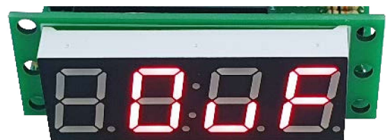
Fotografia 3. Sposób sygnalizacji przepiętnienia licznika
