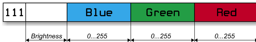
Rysunek 4. Konstrukcja ramki transmisji danych użytecznych diody APA102
