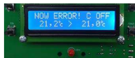
Fotografia 4. Wskazania wyświetlacza z komunikatem błędu czujnika
