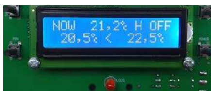
Fotografia 2. Wskazania wyświetlacza w trybie grzania
