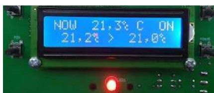
Fotografia 3. Wskazania wyświetlacza w trybie chłodzenia
