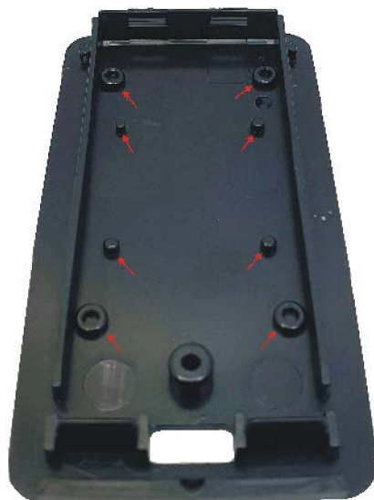
Fotografia 2. Wygląd wnętrza górnej części obudowy z zaznaczeniem nadlewek przeznaczonych do usunięcia
