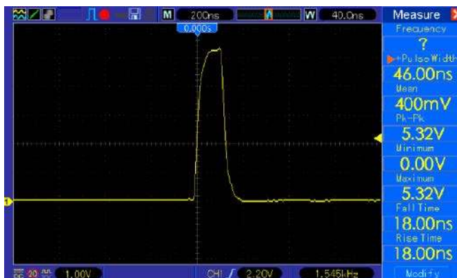
Rysunek 2. Oscylogram impulsu napięcia wyjściowego
