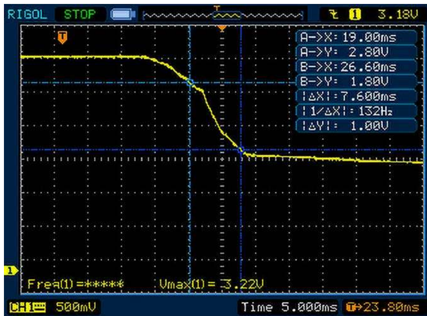
Rysunek 2. Wykres zależności napięcia zasilania mikrokontrolera w funkcji czasu podczas wyłączenia urządzenia
