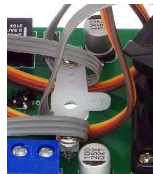
Fotografia 1. Mocowanie przewodów do dużej płytki
