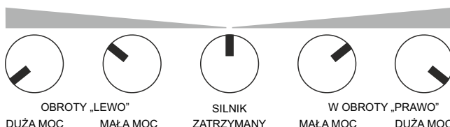
Rys. 1 Reakcja układu na kąt obrotu osi potencjometru
