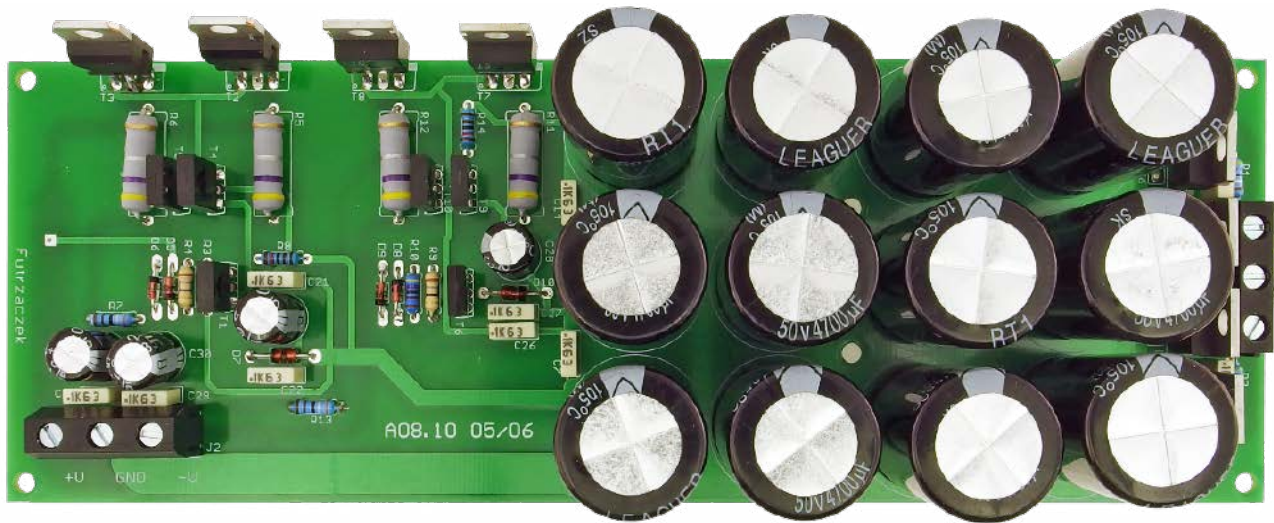
Fotografia 1. Wygląd zmontowanej płytki zasilacza
