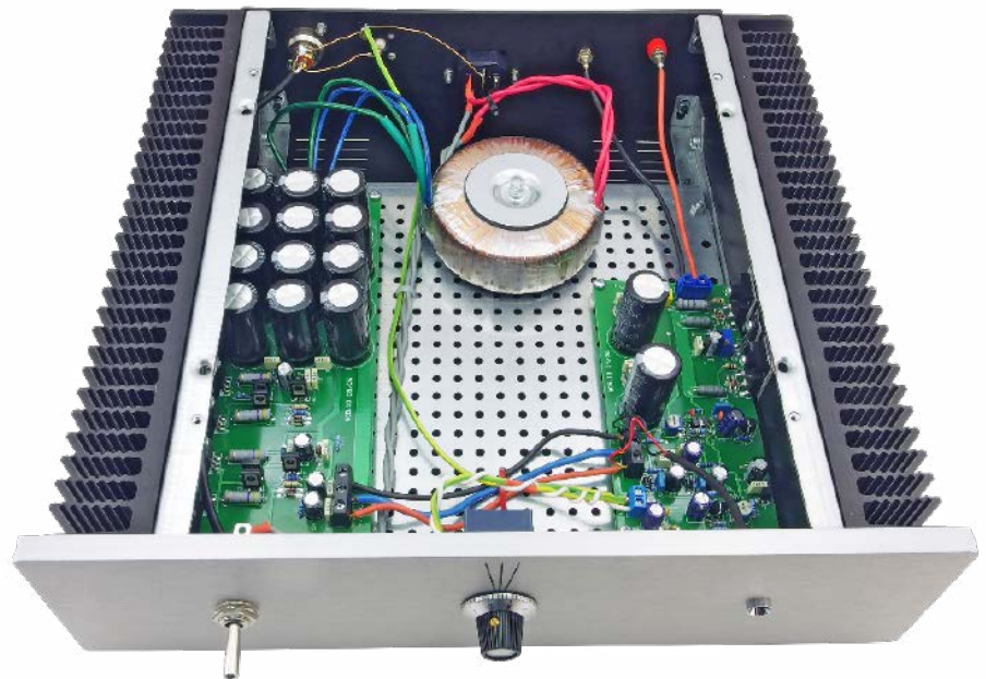
Fotografia 3. Wygląd wewnętrznej konstrukcji wzmacniacza
