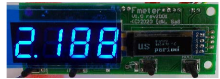
Fotografia 2. Ekran pomiaru czasu okresu sygnału
