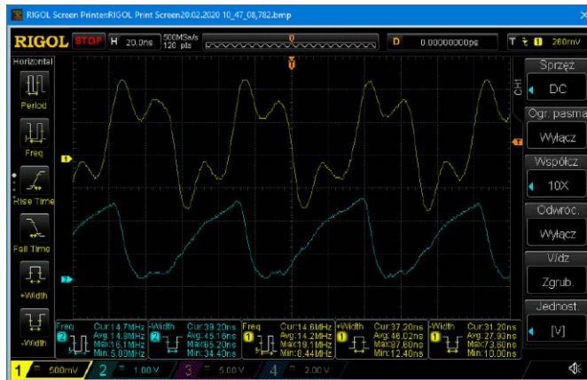
Rysunek 7. Pomiary oscyloskopowe dla częstotliwości 15 MHz
