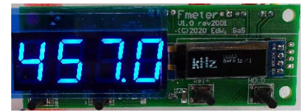
Fotografia 1. Ekran pomiaru częstotliwości
