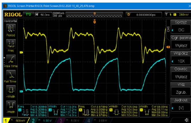
Rysunek 6. Pomiary oscyloskopowe dla częstotliwości 5 MHz
