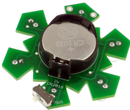
Fotografia 5. Zmontowany układ pokazany od strony baterii
