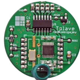
Fotografia 11. Widok zmontowanego węzła pomiarowego od strony TOP
