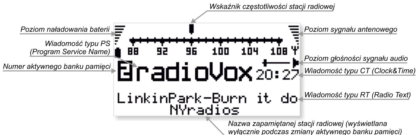
Rysunek 8. Wygląd graficznego interfejsu użytkownika urządzenia radioBox
