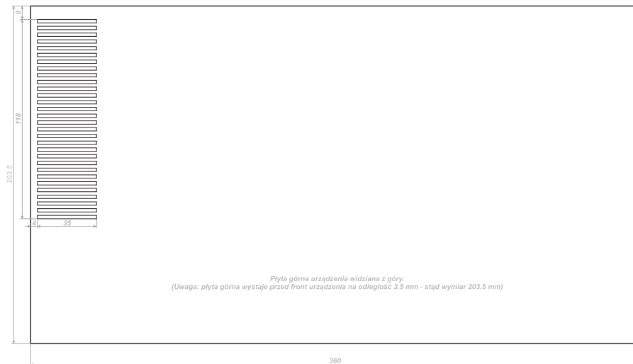
Rysunek 29. Widok płyty górnej amplitunera SAR (widzianej od góry) z zaznaczeniem wszystkich wymiarów
