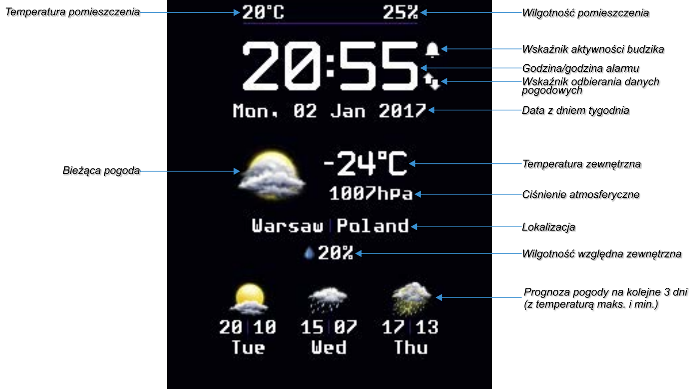
Rysunek 7. Wygląd graficznego interfejsu użytkownika urządzenia wiStation
