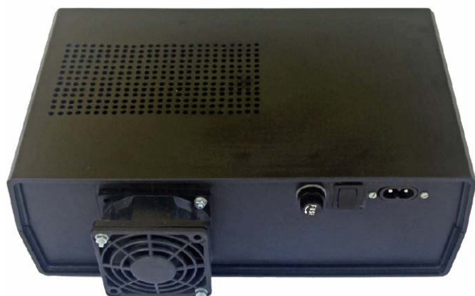
Fotografia 14. Szczegóły montażu elementów na zewnątrz obudowy – góra i tylny panel
