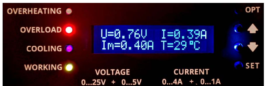
Fotografia 21. Panel sterujący zasilacza w trakcie pracy z ograniczeniem prądowym w trybie ciągłym (@ O_{vdwait}=5000\text{ }\mu\text{s} )
