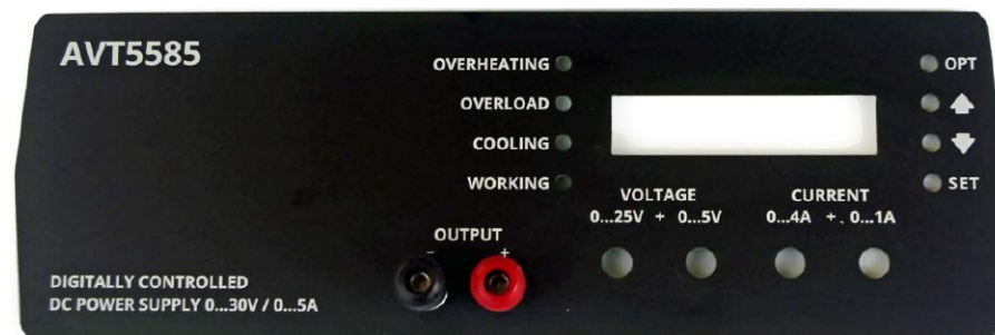
Fotografia 6. Widok płyty czołowej
