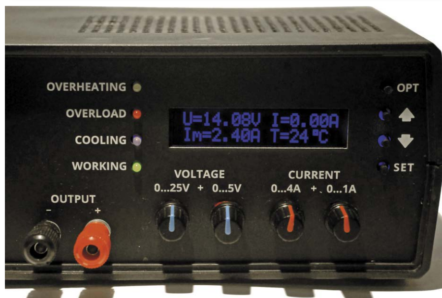
Fotografia 15. Szczegóły montażu elementów na zewnątrz obudowy – panel przedni
