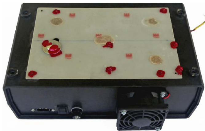
Fotografia 10. Szczegóły zamocowania podzespołów w obwodzie 230 V AC oraz wentylatora 12 V DC (B)
