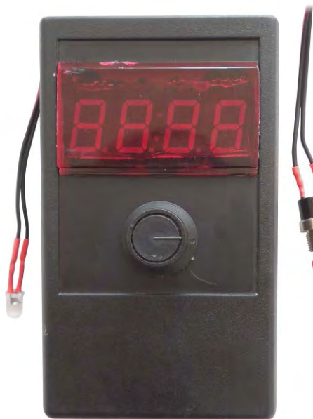
Fotografia 6. Licznik zamknięty w obudowie
