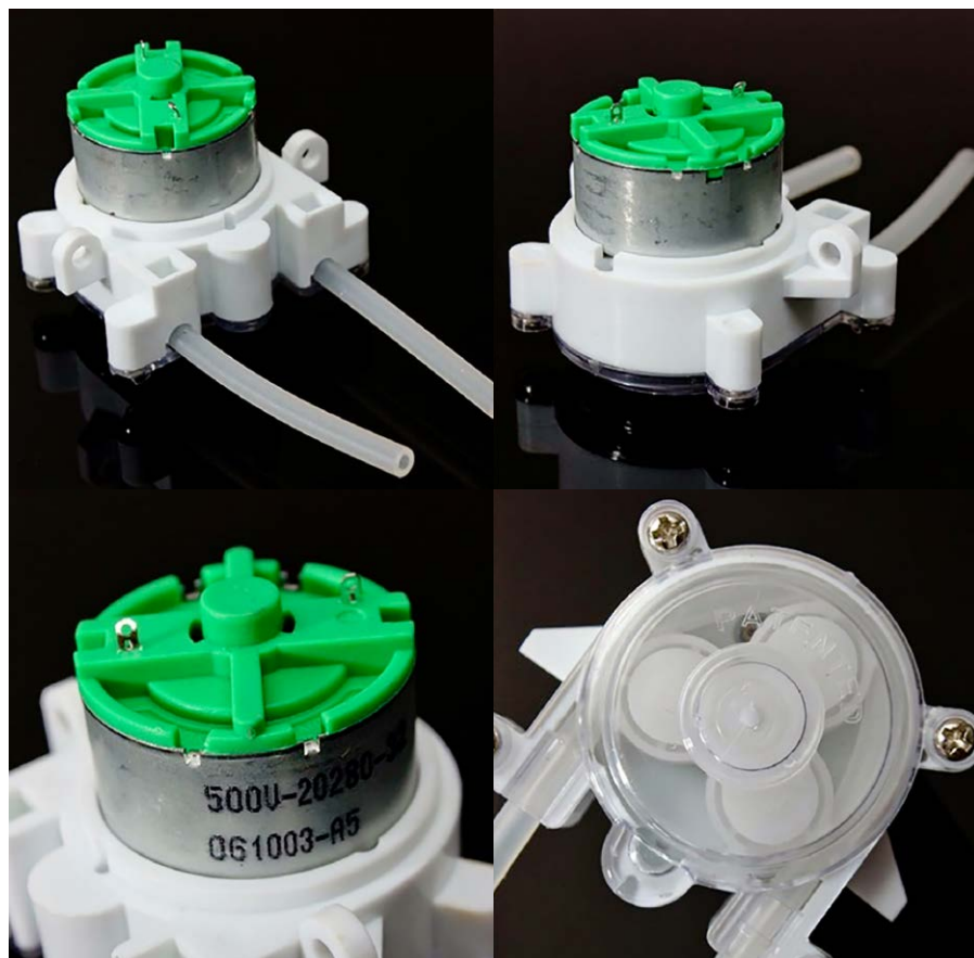
Fotografia 2. Przykładowa pompa perystaltyczna wymaga 6 V/0,35 A i zapewnia przepływ do ok. 60 ml/minutę. Jej wymiary to Ø32 mm×23 mm (silnik) i 54 mm×46 mm (tłocznia). Wężyk ma średnicę ok. 4,5 mm
