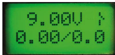
Fotografia 6. Sygnalizacja automatycznego odłączenia obciążenia
