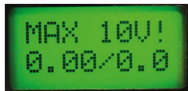
Fotografia 7. Przekroczenie zakresu pracy woltomierza
