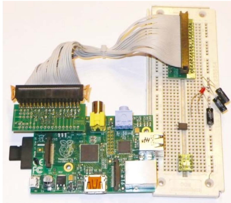
Fotografia 4. Połączenie Raspberry Pi z płytką stykową
