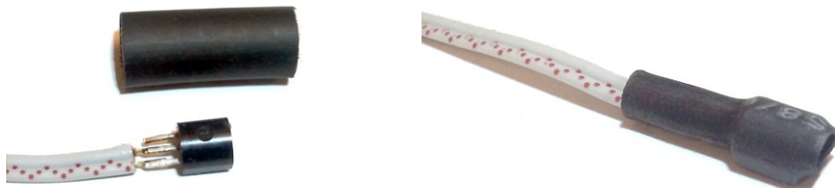
Rys. 5 Przykład zabezpieczenia czujnika za pomocą rurki termokurczliwej
