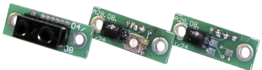
Fotografia 9. Wygląd zmontowanych czujników IFD oraz ILFS w wersjach analogowej i cyfrowej
