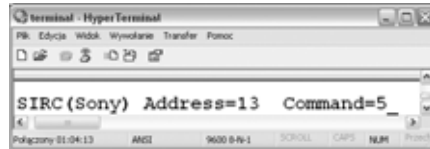
Rys. 5. Przykładowy komunikat wyświetlony w oknie programu HyperTerminal po odebraniu danych w systemie SIRC
