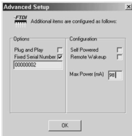
Rys. 20. Okno zaawansowanych ustawień układu FT8U2xxAM
