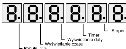
Rys. 4. Znaczenie kropek dziesiętnych przy cyfrach wyświetlacza.
