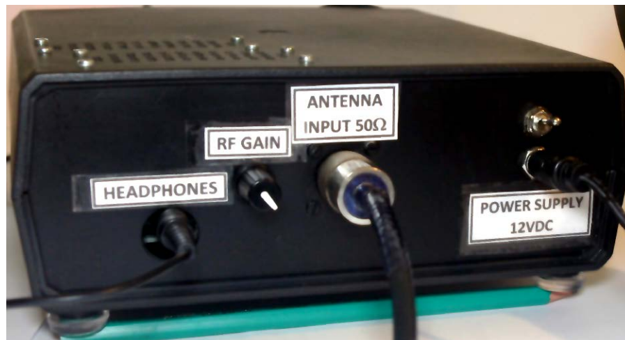
Fotografia 5. Aranżacja i opis tylnego panelu odbiornika
