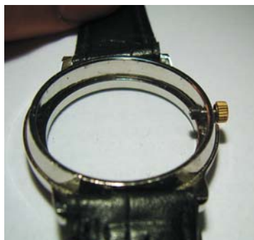
Fot. 4 Sposób zamontowania gałeczki przycisku
