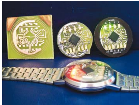
Fot. 7 Kolejne fazy montażu
