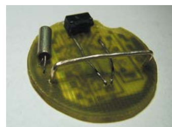
Fot. 5 Zmontowana płytkę od tyłu – mocowanie baterii
