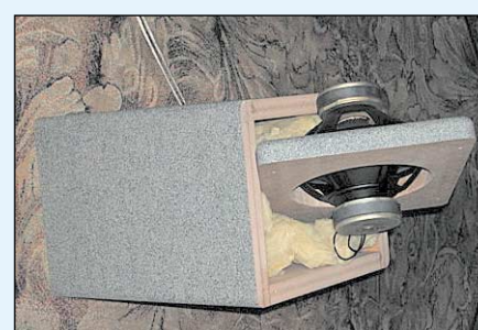
Fot. 1 Zastosowanie dwóch jednakowych głośników w układzie „tandemu”
