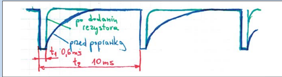
Rys. 12 Przebiegi na wyjściu U3 w części odbiorczej
