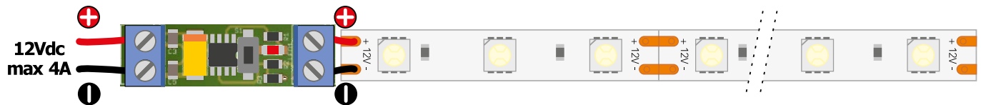
Rysunek 3. Sposób włączenia sterownika w obwód zasilania taśm LED
