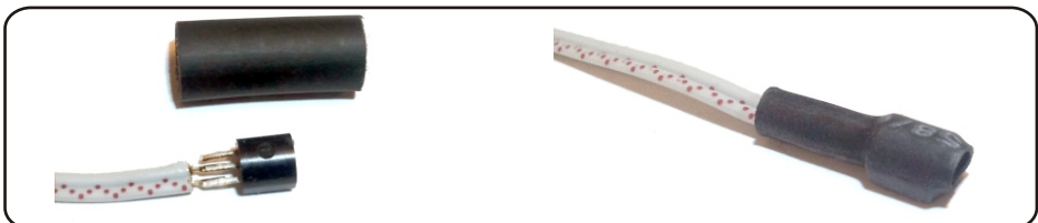
Rys. 6 Przykład zabezpieczenia czujnika za pomocą rurki termokurczliwej
